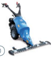
HONDA GX270<br>SUBARU EX27<br>LOMBARDINI 15LD350 | Petrol - <i>Benzin</i><br>Petrol - <i>Benzin</i><br>Diesel - <i>Diesel</i> | 6 / 8<br>6,6 / 9<br>5,5 / 7,5 | Recoil<br><i>Reversierstarter</i> | With gears and worm screw in oil bath<br><i>Mit Spindelgewinde im Ölbad</i> | 4 + 3                | <b>I-1,05</b><br><b>II-2,43</b><br><b>III-3,58</b><br><b>IV-11,15</b><br><b>IRM-1,10</b><br><b>IIRM-2,56</b><br><b>IIIRM-3,77</b>                                           |
