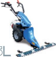
HONDA GX200                                        | Petrol<br><i>Benzin</i>                                                    | 4 / 5,5                       | Recoil<br><i>Reversierstarter</i> | With gears and worm screw in oil bath<br><i>Mit Spindelgewinde im Ölbad</i> | 2 + 2                | <b>I-2,77</b><br><b>II-3,77</b><br><b>IRM-2,63</b><br><b>IIRM-3,58</b>                                                                                                      |
